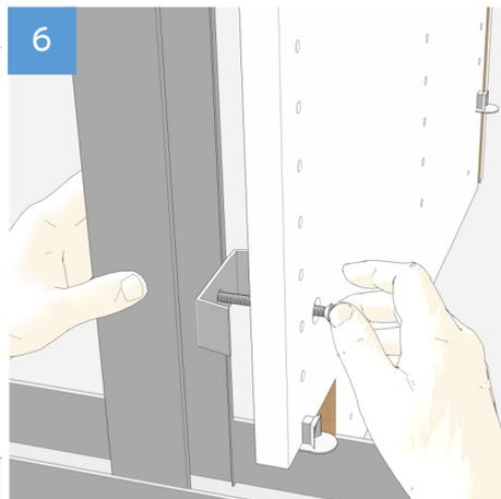
Se monta el panel vertical izquierdo conectándolo al perfil de la estructura mediante las abrazaderas (5). Se presiona el tornillo con el pulgar para que la abrazadera se acople al perfil. Simultáneamente, se empuja con la otra mano el perfil contra el panel, produciendo un sonido similar a un CLIC (6). Se verifica la posición del panel con un nivel láser y se ajustan los tornillos firmemente. Luego se vuelve a comprobar la ubicación y se corrige si es necesario.
