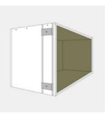
**3** Se colocan perfiles metálicos estándar en las ranuras del panel superior e inferior.
