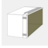
4 La caja se ubica sobre la estructura y se acopla a los perfiles verticales mediante las abrazaderas.
