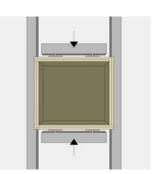
**7** Se colocan las placas de yeso necesarias y se aplica masilla para obtener un acabado uniforme.
