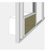
**5** Las cajas se alinean deslizándolas sobre los perfiles de la estructura hasta obtener la ubicación deseada.
